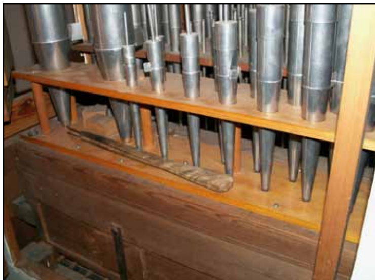
Rörflöjten från 1942 sitter på en ny pipstock på trumpetens gamla plats. Zinkrör förbinder den med basoktaven i Gedacht 8'. Fotograf: Sune Fondell.
