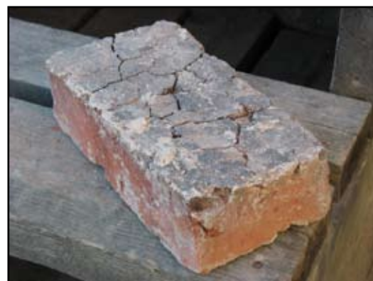
Två prov på vid tidigare restaureringar återanvänt tegel från byggnadstiden, båda med rester av sot som indikerar att de ursprungligen suttit i murstockar. Den övre bilden visar ett påfallande tunt tegel som för tankarna till flensburgtegel, det undre ett vanligt stortegel.
