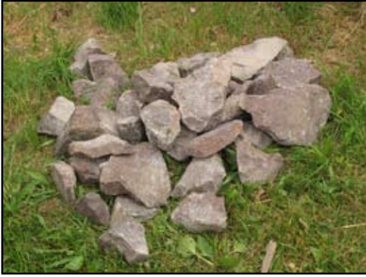
Kompletterande sten för skolning och armering hämtades lokalt och håller samma kulör som befintlig sten.
