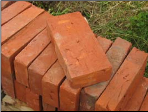
Fönstersmygarnas sidor lagades med handslaget lertegel från Sindal i Danmark.
