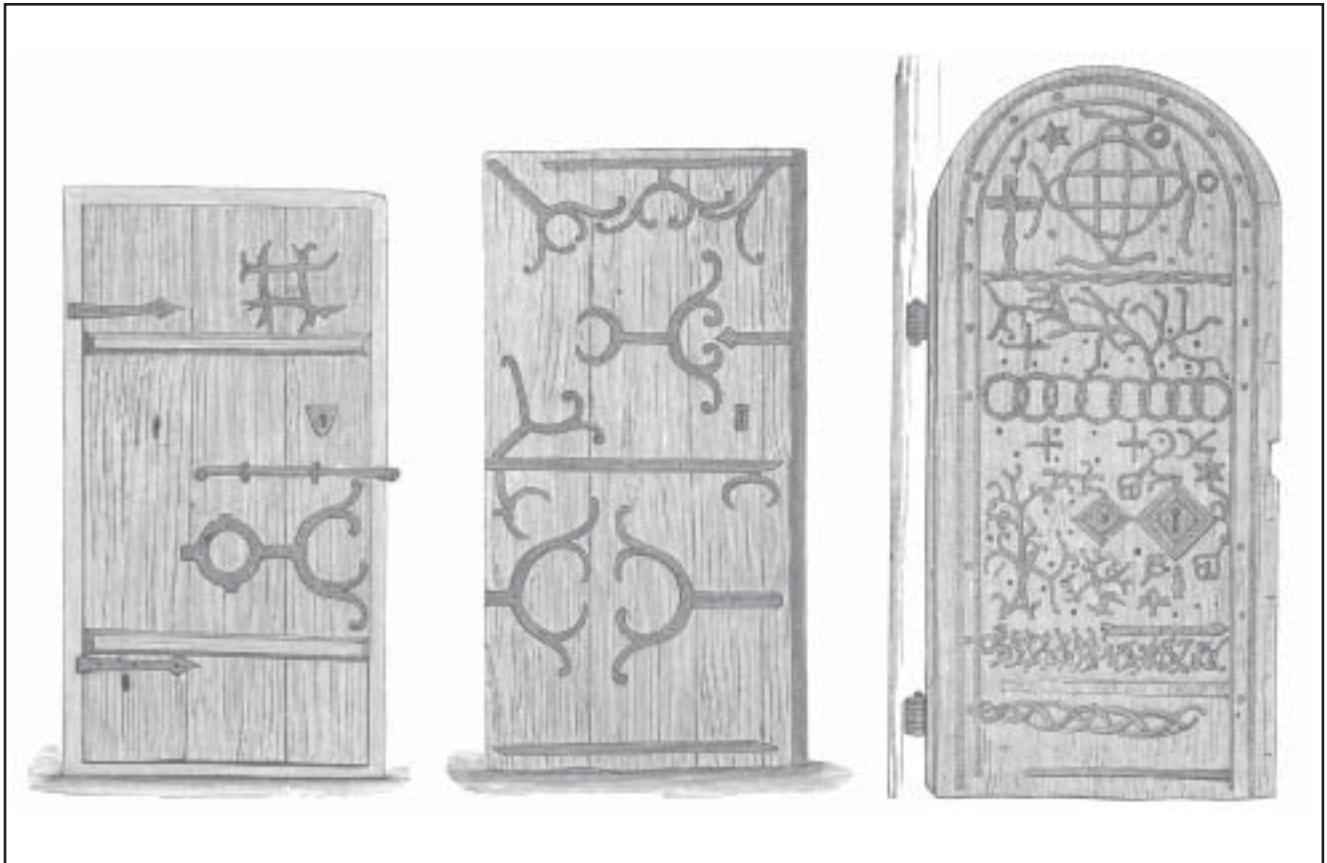
Figur 4. Järnbeklädda dörrar i Brahekyrkan. Från vänster: Dörr vid uppgången till tornet, dörr i sakristian åt kyrkogården samt dörr mellan kyrkan och sakristian.
